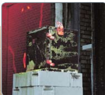
Rimozione dell'armadio dal forno
