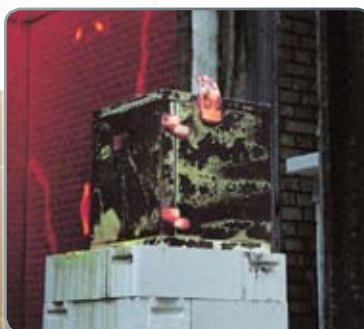
Rimozione dell'armadio dal forno
